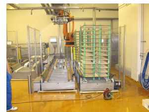
Kabeltromle på vådt gulv kan give stød!
