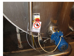
Skiltning om LOCK OUT. Afbryderen til maskinen er slukket, og der er sat hængelås
