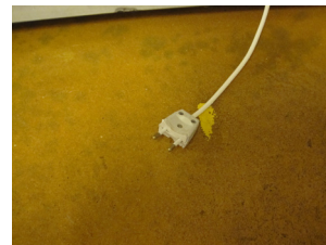
Stik uden jord og med beskadiget plastickappe
